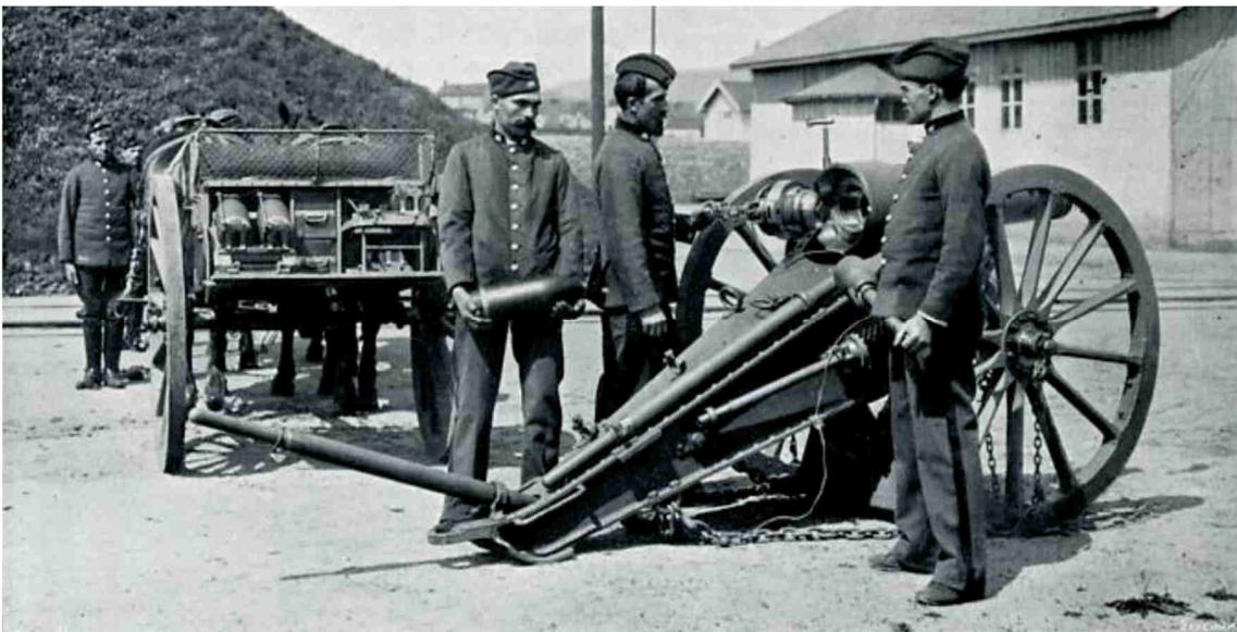
Figura 12 – Obuseiro Schneider-Canet sérvio de 150mm, modelo 1897.
