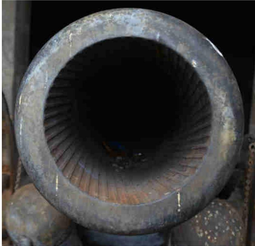
Figura 7 – Interior do tubo, mostrando o raiamento.
